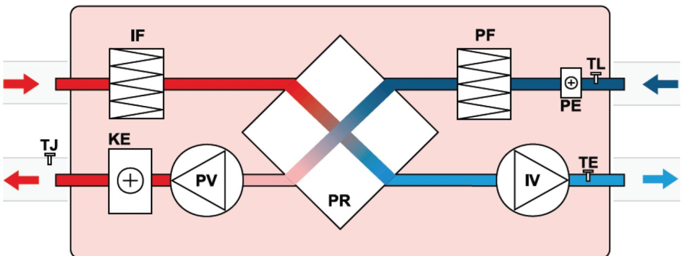
PV – вентилятор приточного воздуха;
