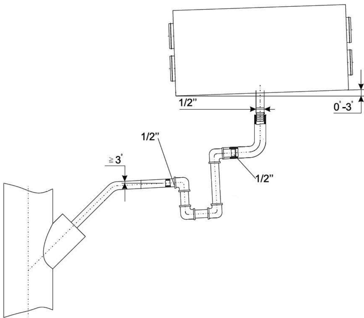
Перед запуском установки дренажная трасса должна быть испытана, а сифон - заполнен водой.
