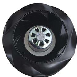
В оборудовании установлены надежные, высокоэффективные, вентиляторы Ebmpapst и Ziehl-Abegg. Электронно коммутируемые вентиляторы (ЕС) с управлением по линии 0...10в. ЕС-Вентиляторы регулируются в диапазоне от 20% до 100% с точностью в 1%, это позволяет максимально точно подвести воздухообмен к расчетным/проектным значениям. Приточный и вытяжной вентиляторы настраиваются отдельно, что позволяет балансировать приточную и вытяжную линии изменением настроек вентиляторов.
