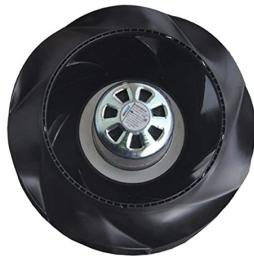
В оборудовании установлены надежные, высокоэффективные, вентиляторы Электронно коммутируемые вентиляторы (ЕС) с управлением по линии 0...10в. ЕС-Вентиляторы регулируются в диапазоне от 20% до 100% с точностью в 1%, это позволяет максимально точно подвести воздухообмен к расчетным/проектным значениям. Приточный и вытяжной вентиляторы настраиваются раздельно, что позволяет балансировать приточную и вытяжную линии изменением настроек вентиляторов.
