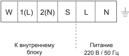
Клеммы для подключения проводов на наружном блоке
